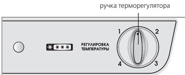
**Рисунок 9 — Регулировка температуры**
